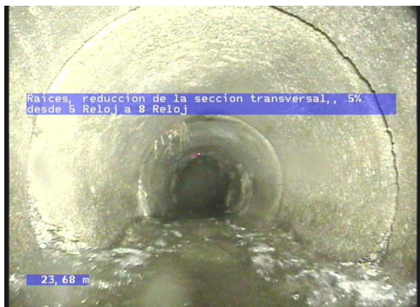
2-2-8A, 00:05:43.38, 23.68 Raíces, reducción de la sección transversal,, 5% desde 5 Reloj a 8 Reloj
