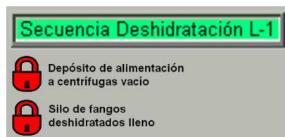
Ilustración 9- Secuencia en espera o modificada por condiciones adicionales.
