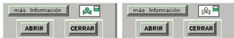
Ilustración 26- Botonera válvulas todo-nada (posición abierto y cerrado)
