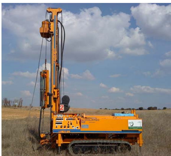
Figura 7. Equipo de penetración dinámica. Tipo DPSH-B.
