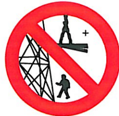
prohibido circular bajo cargas suspendidas
