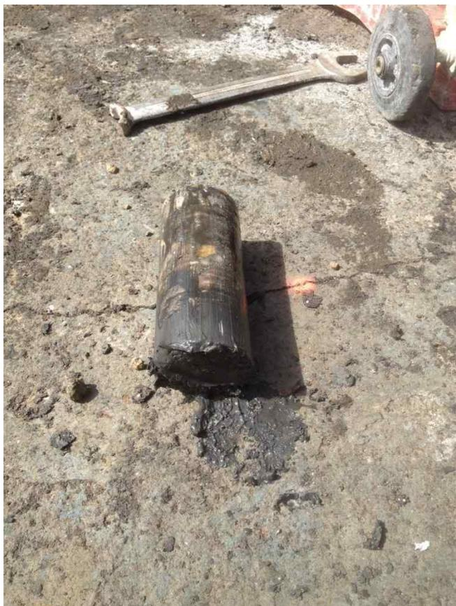
**Foto 5. Fango en el fondo del cilindro extraído en la perforación. Obsérvese la grieta en la solera**
