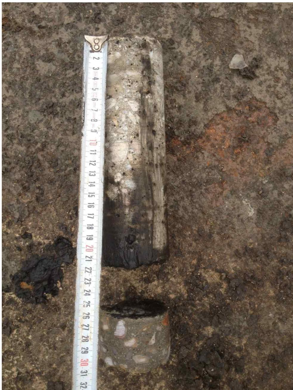
**Foto 3. El testigo de la solera discurre desde 0 a 21,5 cm. El testigo de 26 cm a 31 cm es el del hormigón de limpieza que cede por el lavado del relleno granular.**
