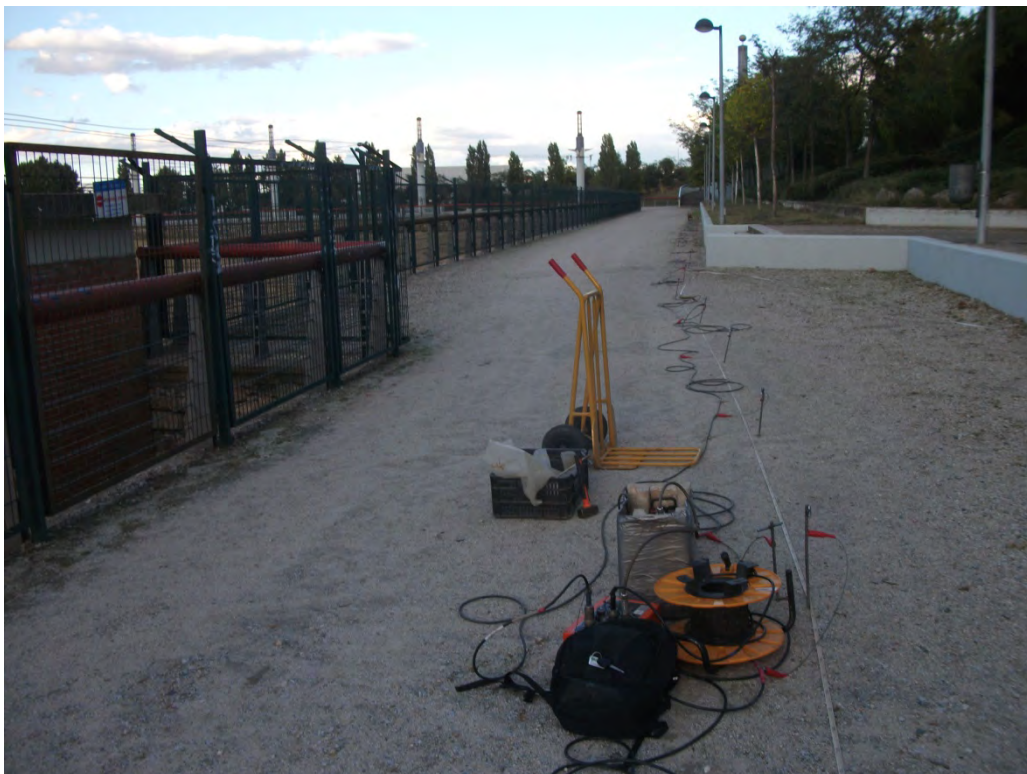
Fotografía 6.: Realización de TE02. Vista desde el centro al final del perfil 02.
