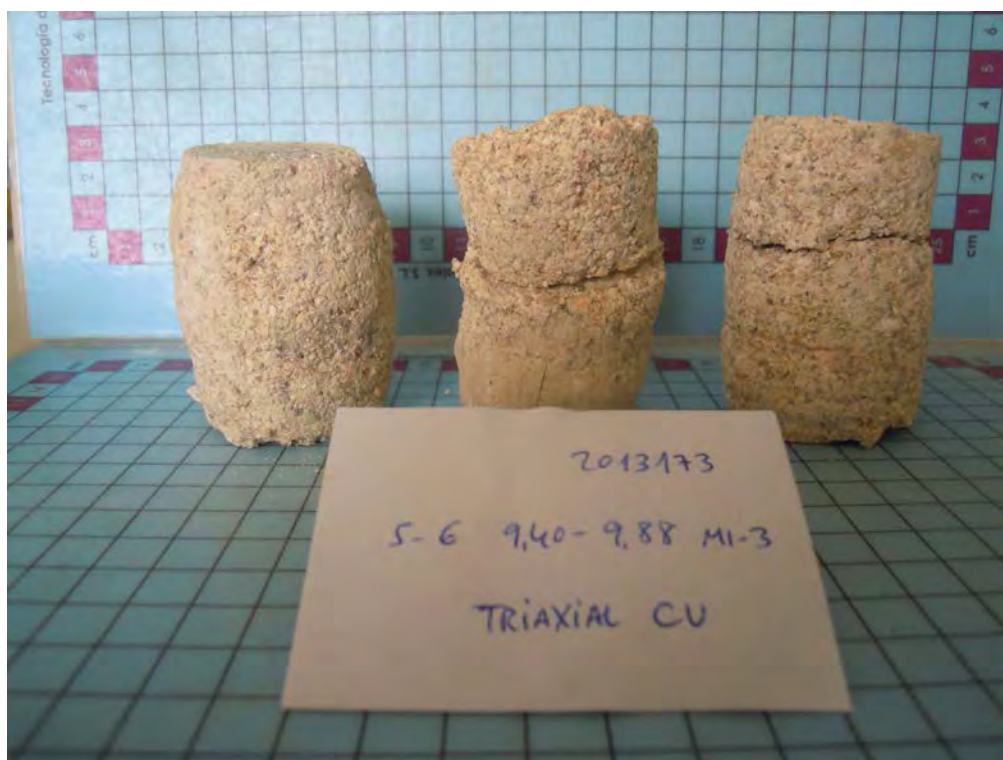
Detalle de las probetas después de ser sometidas a ensayo
