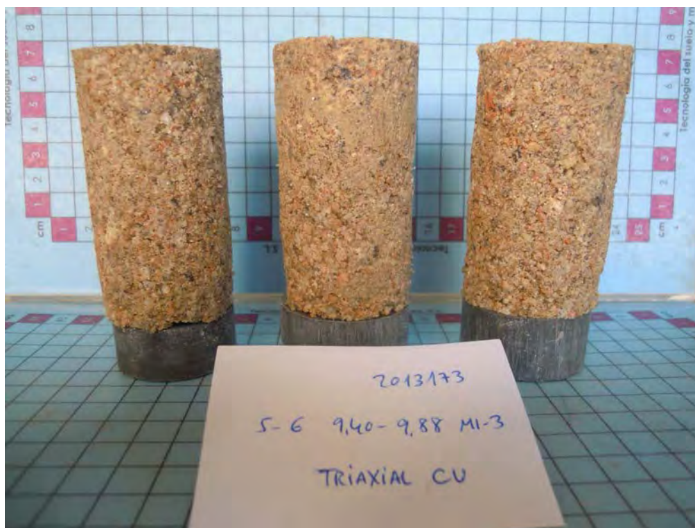
Detalle de las probetas antes de ser sometidas a ensayo
