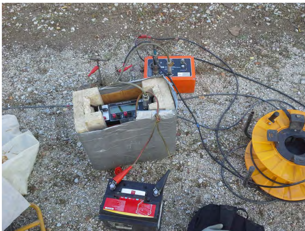
Fotografía 02.01. Terrámetro SAS-4000 de ABEM empleado en la campaña de campo.
