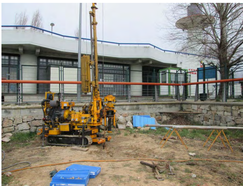
Fotografía 3: Máquina de sondeos CEFRE XCH-90 durante la ejecución del sondeo SD-3
