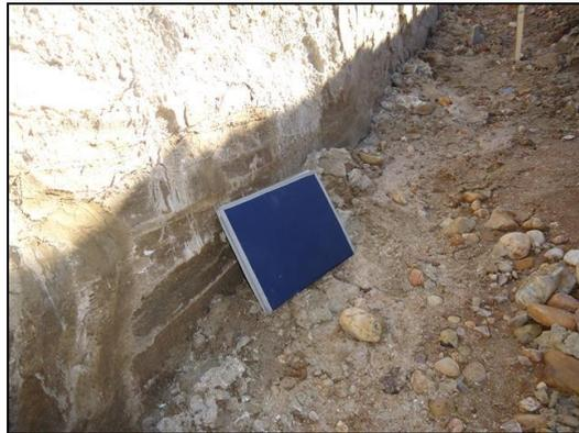
Detalle de los materiales aflorantes, arenas, limos y arcillas
