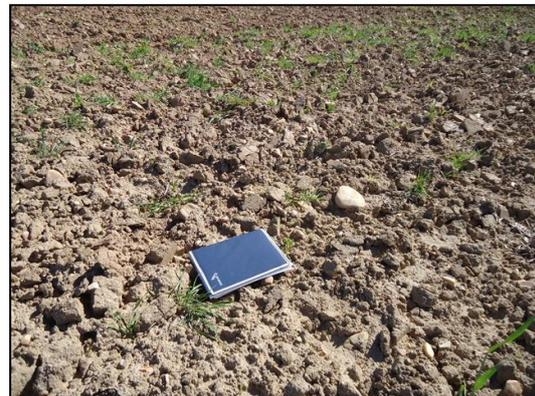
Aspecto de los materiales aflorante en superficie, formados por un suelo edáfico arcillo-arenoso con cantos y bolos.
