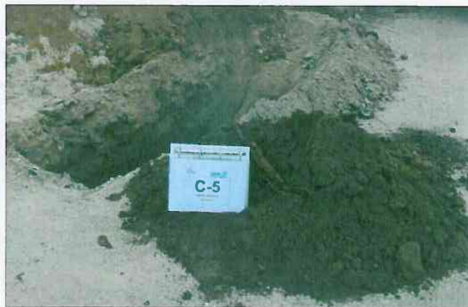
Fotografía 6: Acopio de material de la unidad UG-3 detectado en la calicata C-5
