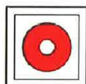
R. PULSADOR DE ALARMA
