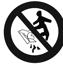
PROHIBIDO PISAR SUELO NO SEGURO
