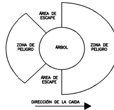
RUTAS DE ESCAPE QUE DEBEN ESTAR DESPEJADAS ANTES DEL APEO
