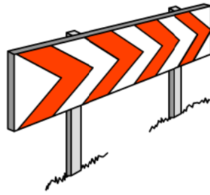
PANELES DIRECCIONALES PARA CURVAS
