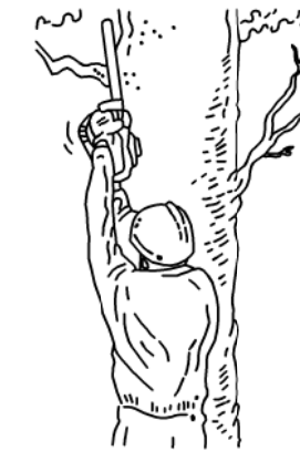
NO CORTAR NI TALAR CON LA MOTOSIERRA TODO AQUELLO SITUADO POR ENCIMA DEL HOMBRO
