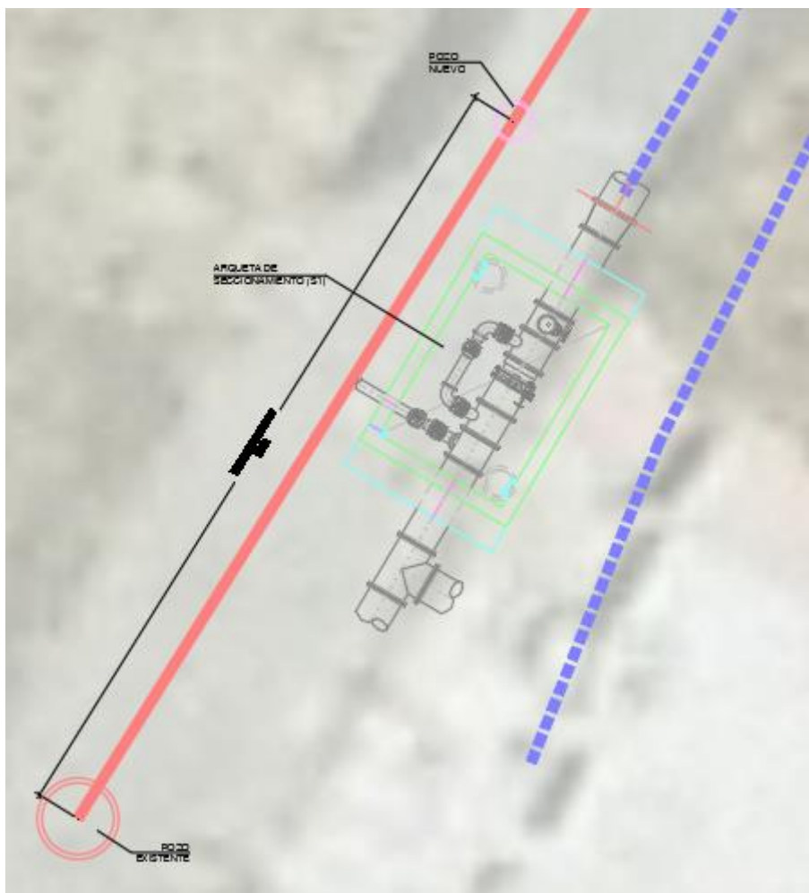
Imagen 28: Reposición de colector de saneamiento.
