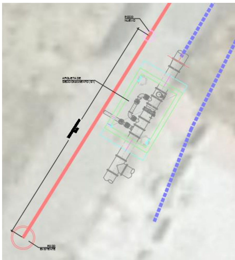
Imagen 26: Reposición de colector de saneamiento.
