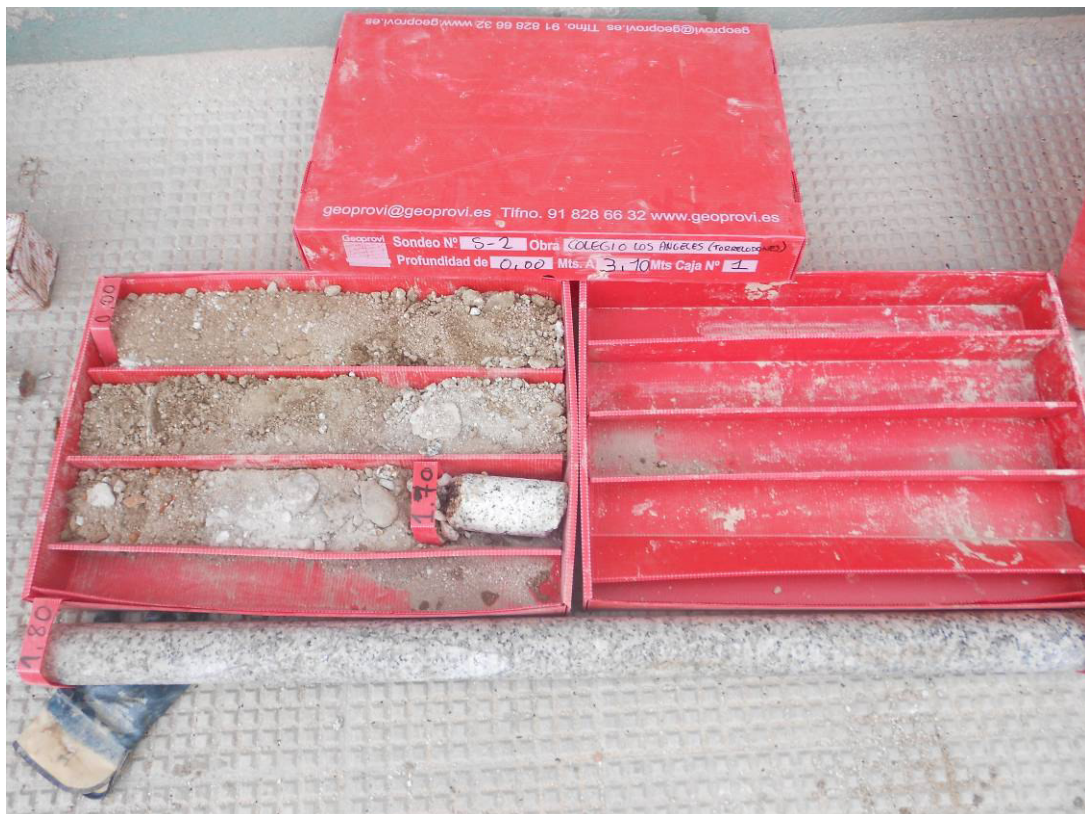
Cajas portatestigo de sondeo S-2, Edificio 3
