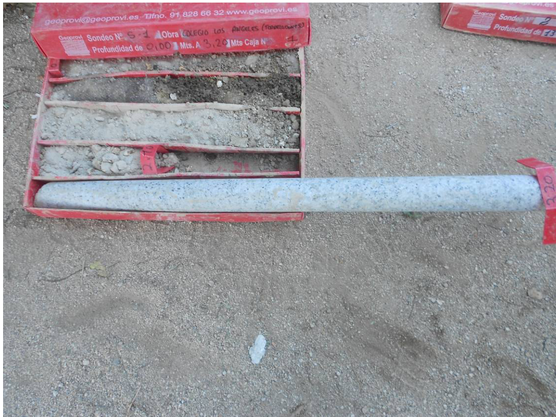
Cajas portatestigo de sondeo S-1, Edificio 2
