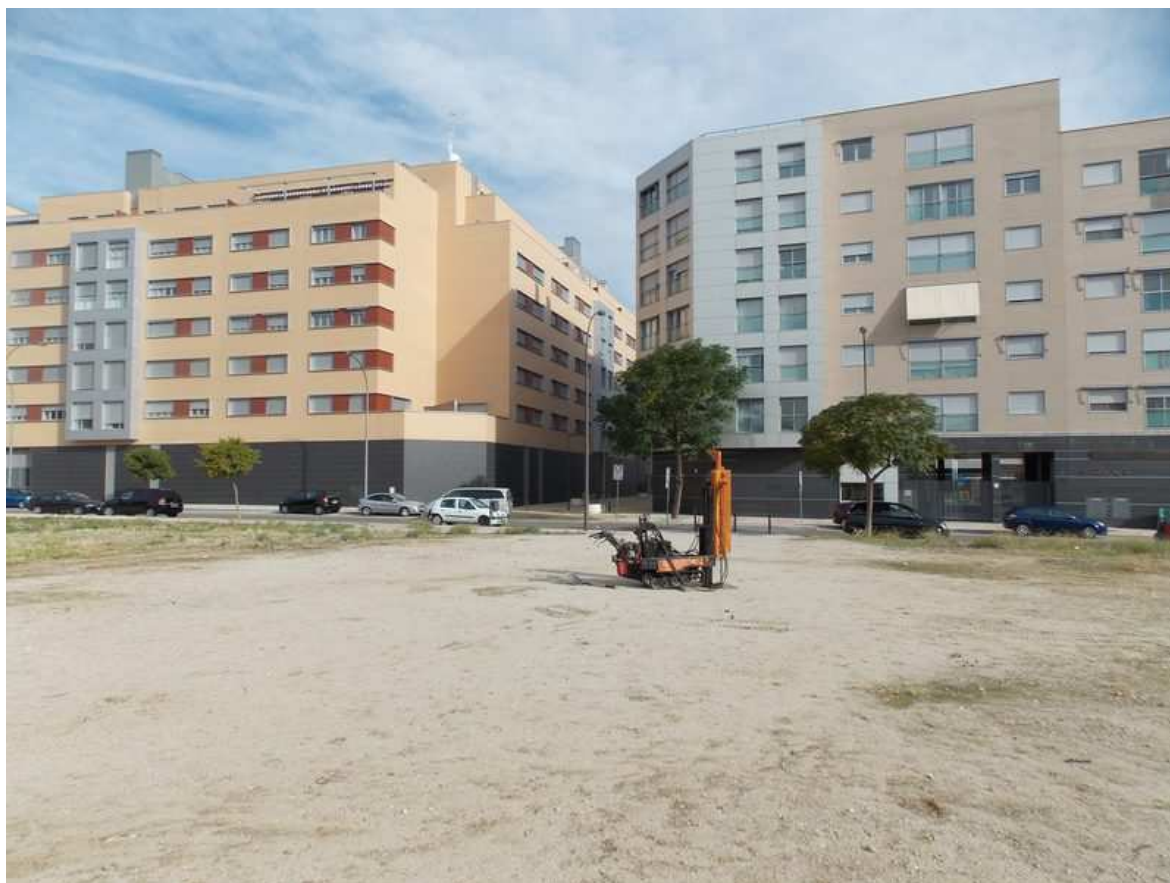
FOTOGRAFIA 16: Vista de la realización del penetrómetro 4.
