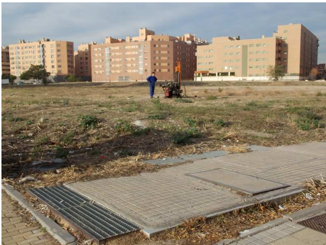
FOTOGRAFIA 13: Vista de la realización del penetrómetro 1.
