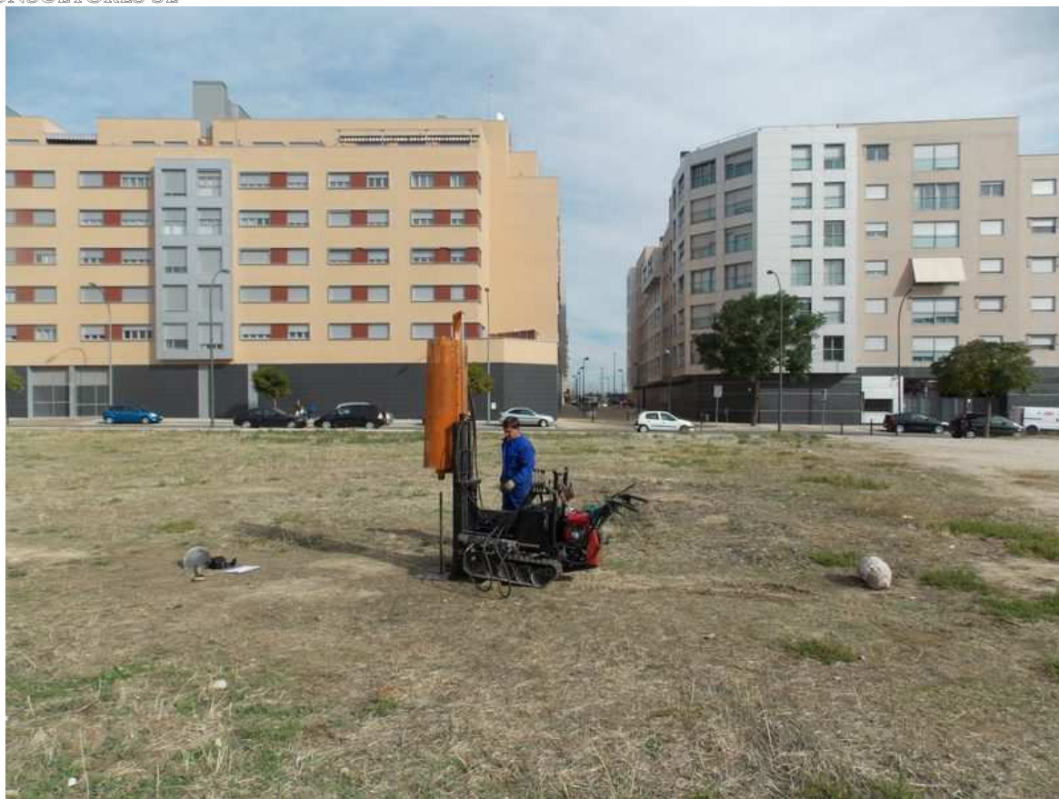
FOTOGRAFIA 19: Vista de la realización del penetrómetro 7.
