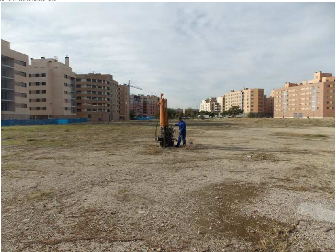
FOTOGRAFIA 15: Vista de la realización del penetrómetro 3.
