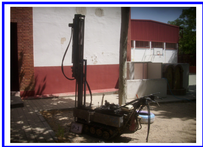
Ensayo de penetración dinámica P-1
