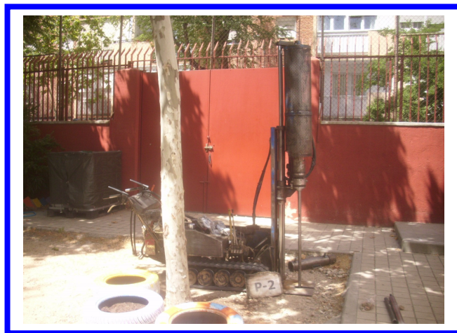
Ensayo de penetración dinámica P-2
