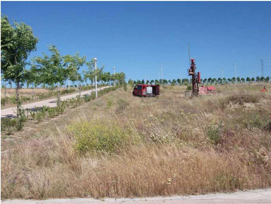
FOTOGRAFIA 1: Vista de la realización del sondeo 1 y penetrómetro 1.
