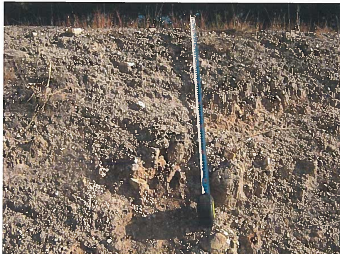
FOTO 5.- Detalle de los materiales terciarios arcósicos en la cara del talud existente, obsérvese los cantos de cuarzo y de fragmentos de roca incluidos en las arenas.
