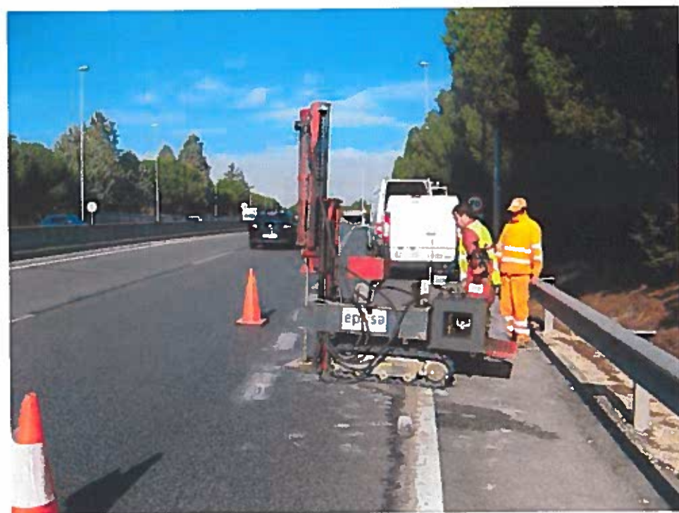
FOTO 9.- Vista de la Penetración Dinámica P-2.
