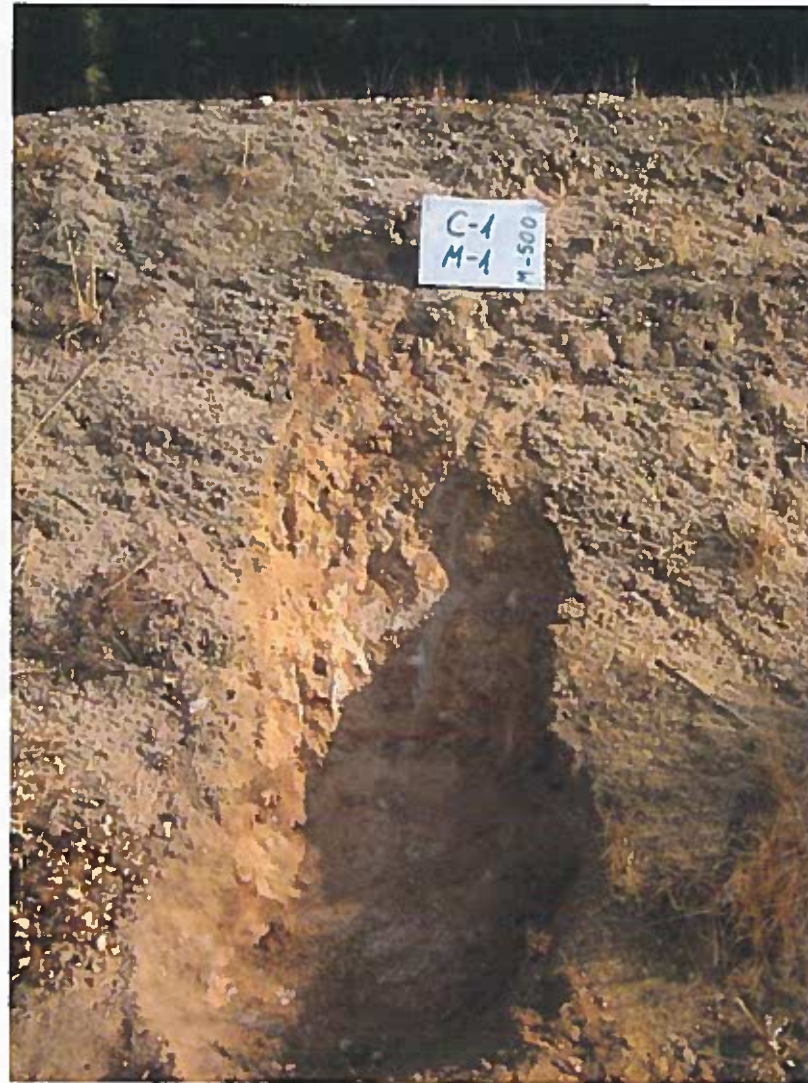
FOTO 1.- Excavación realizada para la calicata manual C-1, en el talud derecho de la M-500. Litológicamente son arenas gruesas arcósicas con cantos de cuarzo y fragmentos de rocas ígneas.
