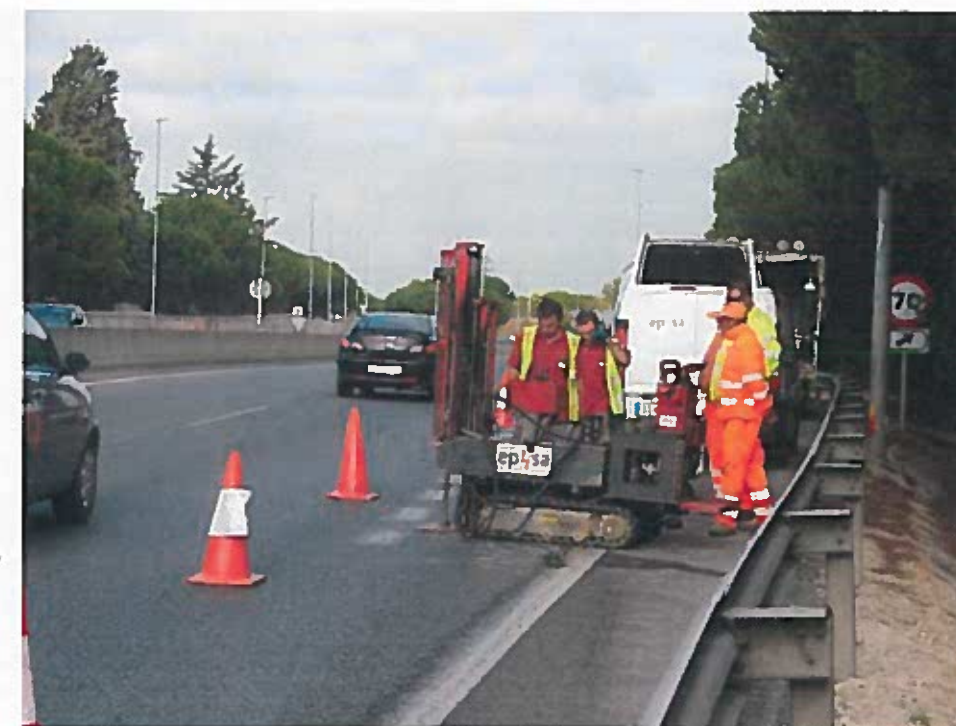
FOTO 7.- Vista del Ensayo de Penetración Dinámica P-1.
