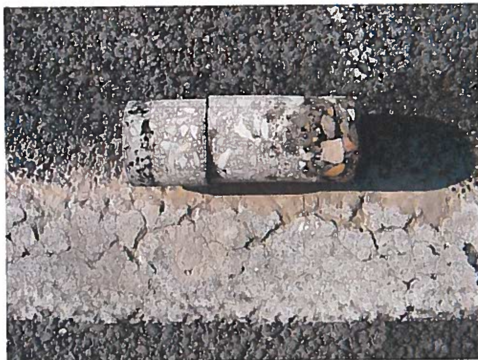
FOTO 8.- Detalle del Testigo de Firme T-2.
