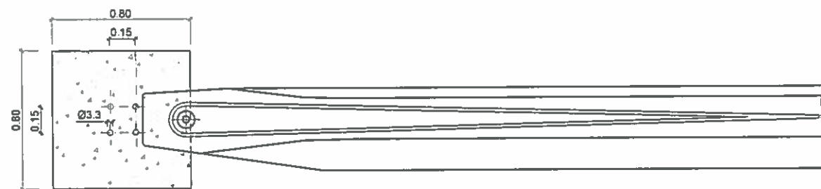
PLANTA PIEZA TERMINAL PRETIL DE HORMIGÓN DE CONTENCIÓN H2 ESCALA 1:15
