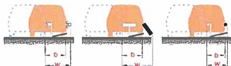
Fig.- 4: Deflexión dinámica y ancho de trabajo.
