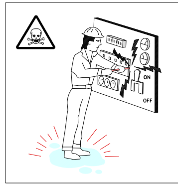
REPARACION DE EQUIPOS BAJO TENSION
