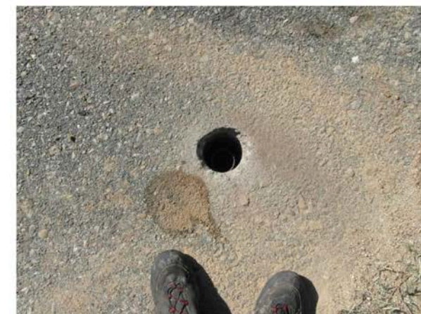
Sondeo S01 finalizado a 8,00 metros de profundidad.
