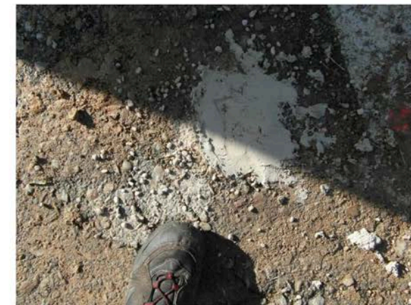
Sondeo S02 finalizado y sellado con mortero.
