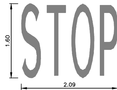
MARCA VIAL DE STOP ESCALA 1:50 M-6.4 VIA CON VM < 60 Km/h
