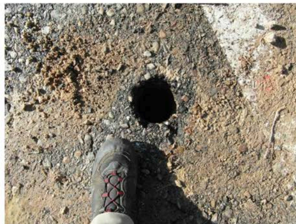
Sondeo S02 finalizado a 9,00 metros de profundidad.
