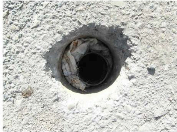
Sondeo S01 finalizado con tubería de control de freático previa colocación de tapa.
