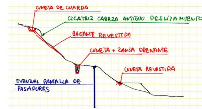
Figura 6.5 – Medidas de mejora de la estabilidad de ladera
