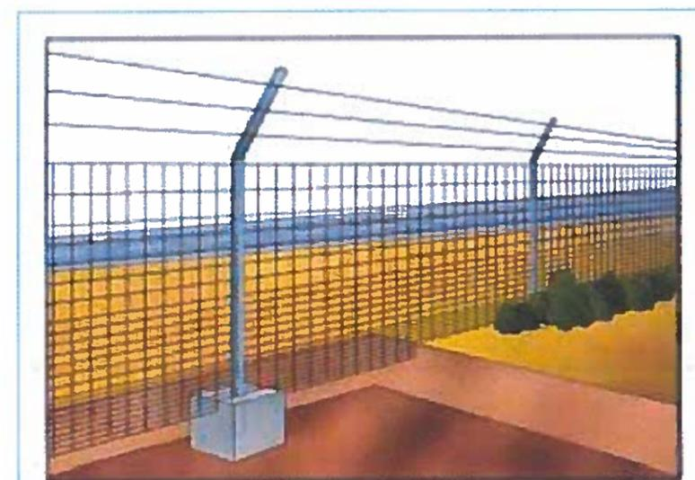
Figura 12: Esquema general de cerramiento perimetral para grandes mamíferos. Fte. Ministerio de Medio Ambiente. 2006. Prescripciones técnicas para el diseño de pasos de fauna y vallados perimetrales
