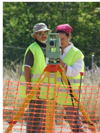
Toma de datos topográficos para la elaboración de una planimetría.
