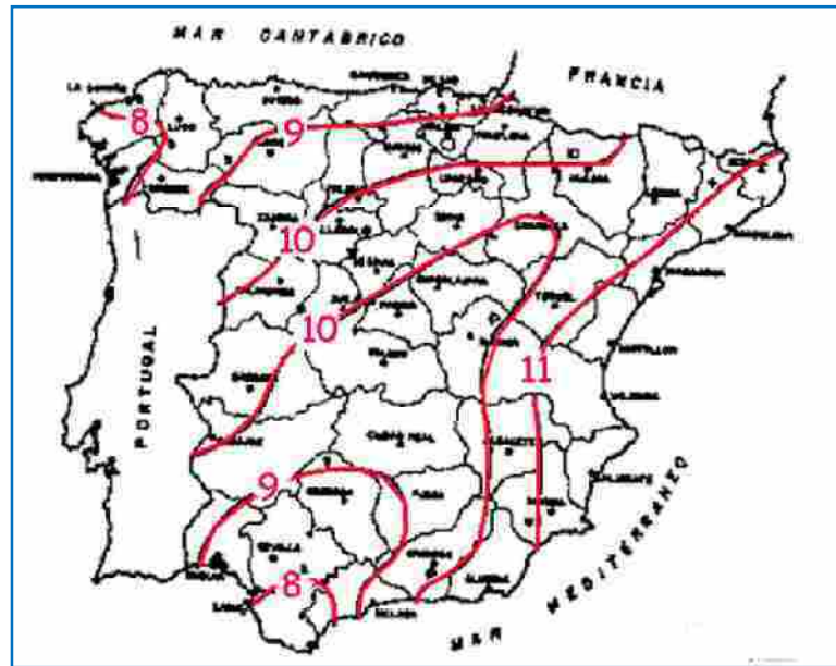
Figura 5. Relación entre las Intensidades de Lluvia horaria y diaria (I1 / Id). Fuente: Instrucción de Carreteras 5.2-IC. 1990.
