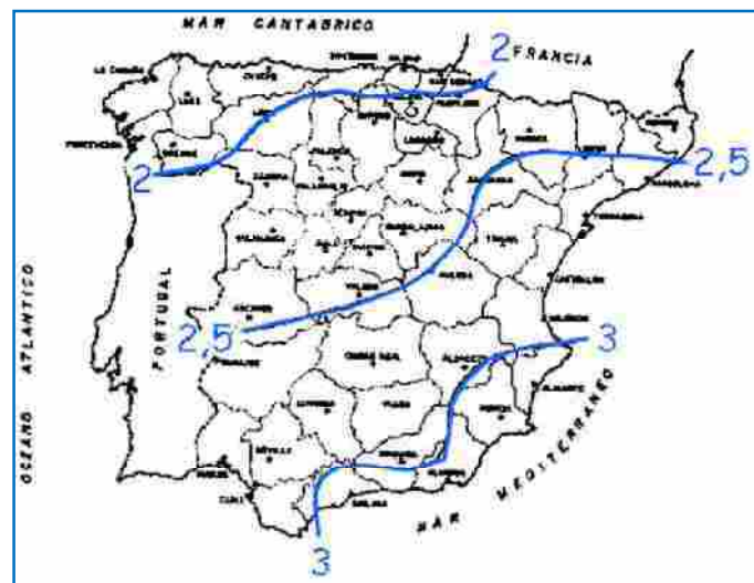
Figura 6. Coeficiente corrector del umbral de escorrentía.
