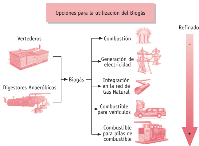
FIGURA 27 Opciones para la utilización del biogás.
