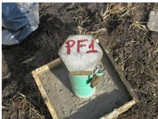
Ejemplos de piezómetros de control
